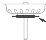
O-Ring für Siphon-Exzenter-Verschluss 2x
