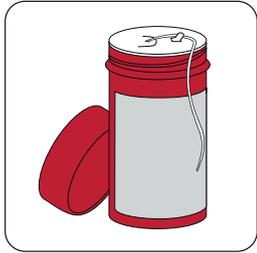
1 Ein Stück von dem Gewindedichtfaden/ -band abtrennen.
