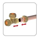
5 Klemmkörper auf das Rohr aufstecken.
