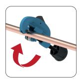
1 Kupferrohr mit Kupferrohrschneider oder feiner Metallsäge passend ablängen.
