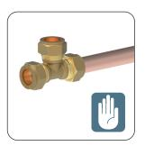
6 Klemmringverschraubung mit der Hand festdrehen.
