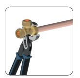
7 Klemmringverschraubung mit der Zange fest anziehen.\*
