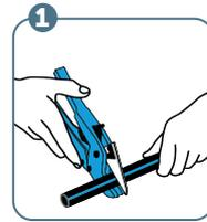
HDPE-Kaltwasserrohre mit Säge oder Schere für Kunststoffrohr rechtwinklig ablängen, Schnittkanten mit Feile entgraten und anfasen.
