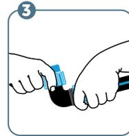
Überwurfmutter mit der Hand fest anziehen, fertig! Falls nötig mit einer Rohrzanze festdrehen.
